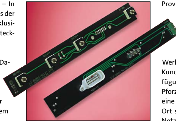
Bild 3: Seat Row Indikator-Platine – Medienbedienpanels in Verkehrsflugzeugen; die Platine aus Sondermaterial muss mit SMD-Bauteilen und vier Spezialtastern von Hand plan verlötet werden.
